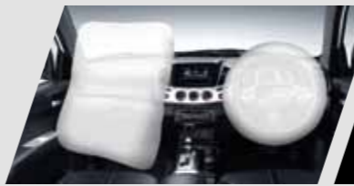
ระบบถุงลมนิรภัยคู่หน้า SRS โดยทำงานร่วมกับระบบเข็มขัดนิรภัยแบบดึงกลับอัตโนมัติ (เฉพาะรุ่น Double Cab 4x4 GLS Ltd.)
