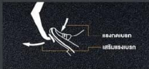
BRAKE ASSIST (BA) ระบบเสริมแรงเบรก จะทำงานทันทีที่เหยียบเบรกกะทันหัน ระบบนี้จะช่วยเพิ่มแรงดันน้ำมันเบรกให้มากขึ้น เพื่อช่วยให้การหยุดรถเป็นไปอย่างรวดเร็ว
