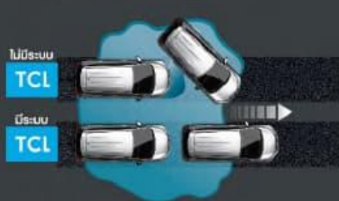
TRACTION CONTROL SYSTEM (TCL) ระบบป้องกันล้อหมุนฟรีและควบคุมการลื่นไถล ระบบจะช่วยควบคุมการหมุนของล้ออย่างสมดุลในสภาวะถนนลื่น เพื่อไม่ให้รถสูญเสียการยึดเกาะถนน
