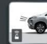
WELCOME LIGHT ระบบไฟสว่างอัตโนมัติเมื่อปลดล็อก เมื่อคนขับปลดล็อกบนกุญแจรีโมทไฟรั้วและไฟท้ายจะทำงานเป็นเวลา 30 วินาที (ระบบนี้จะทำงานเมื่อสวิตช์ชุดไฟนำอยู่ในตำแหน่ง OFF)
