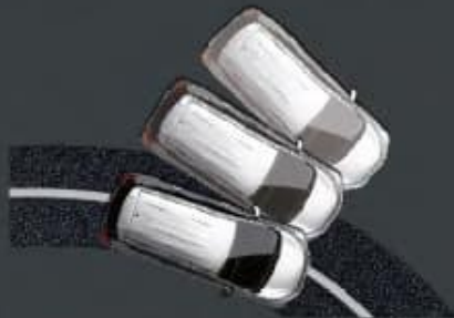
ACTIVE STABILITY CONTROL (ASC) ระบบควบคุมเสถียรภาพการทรงตัว ในสภาวะที่รถเสียสมดุล เพื่อช่วยควบคุมการเกิดการลื่นไถลออกนอกเส้นทาง เช่น กรณีหลุดโค้งเมื่อเข้าโค้งด้วยความเร็วสูง ถนนลื่น หรือหักหลบกะทันหัน
