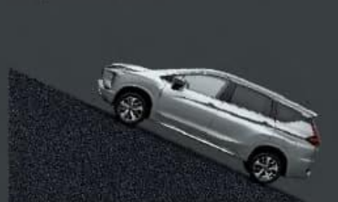
HILL START ASSIST (HSA) ระบบช่วยออกตัวบนทางลาดชัน ช่วยป้องกันรถไหลเมื่อต้องจอดที่ตัวบนทางลาดชัน
